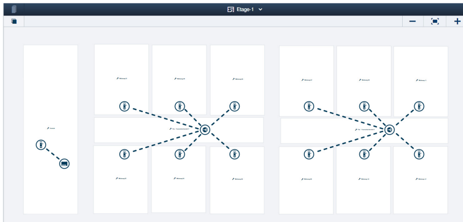
Abb. 62: Gebäudestruktur: Wohngebäude mit mehr als 10 Meter Übertragungsstrecke und Funksignalhemmung durch Feuerschutzwände
