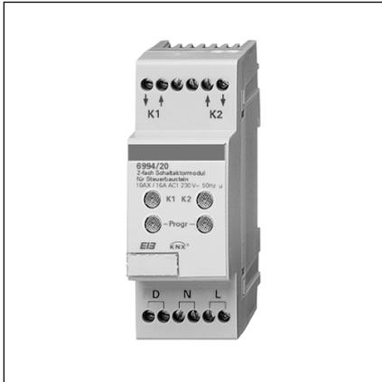
Das Schaltaktormodul 2fach ist ein Reiheneinbaugerät für den Verteilereinbau. Das Modul wird an den Powernet EIB-Steuerbaustein angeschlossen und kann 2 unabhängige Lasten mit max. 16 Ax je Ausgang schalten.
