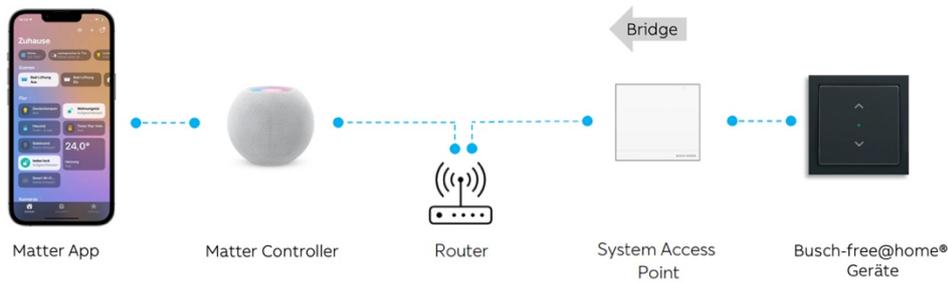
Bild: Die Busch-free@home® Geräte können über die neue Bridge-Funktion im System Access Point via Router und einem Matter Controller, wie beispielsweise Apple HomePod, in jeder Matter-fähigen App angezeigt werden.
